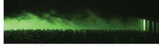
高層ビル群が作り出す風の道の可視化実験
