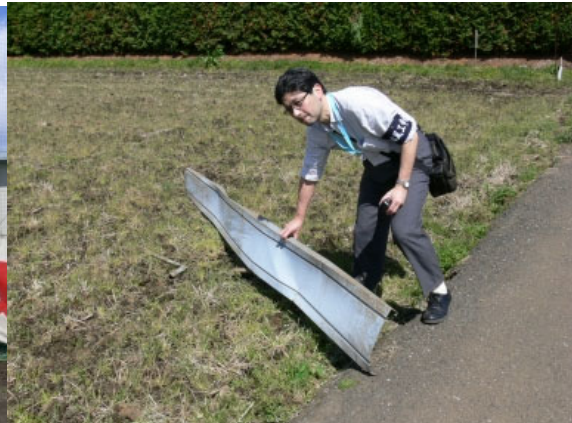
温室(ガラス張り)の被害, 手前の鉄製の井戸の蓋が飛散した。
